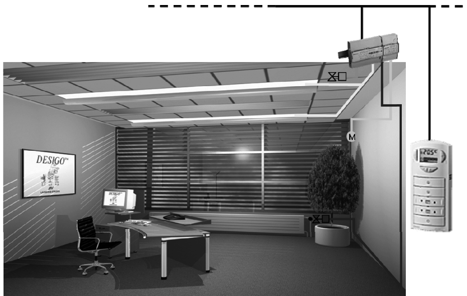
Интегрированная работа управления климатом, освещением и жалюзи с DESIGO RXC
